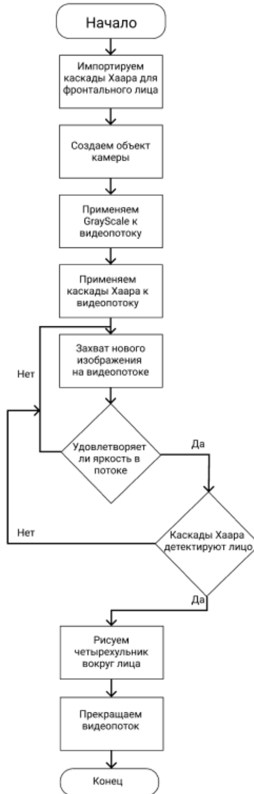
Рисунок 2.7 – Блок-схема алгоритма для детектирования лиц
