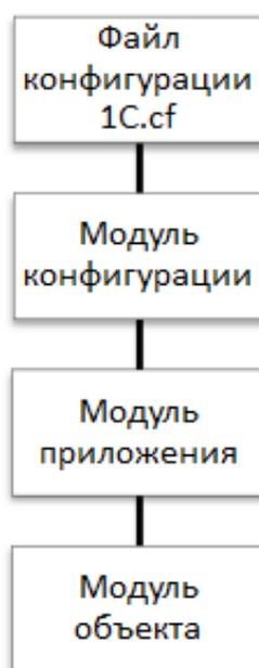
Рисунок 9 – Схема взаимосвязи программных модулей и информационных файлов
