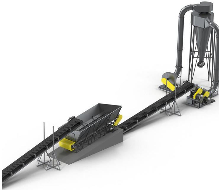
Рисунок 3.1 – Линия производства щепы для копчения мясных и рыбных продуктов ЛПЩ-ДСП/ДВП
